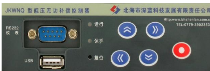
图 5 JKWNQ 型控制器面板图（最右边按键为确认键）
